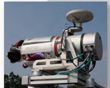
горизонтальная установка, например, для съемки дорожного покрытия
