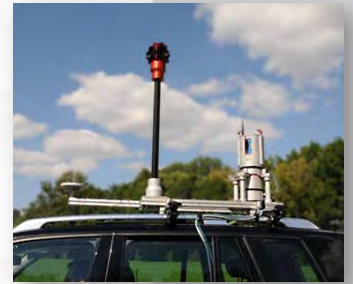
вертикальная установка сканера с дополнительной панорамной камерой
